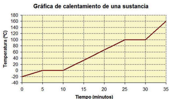
Imagen 19. Grafica T-t Aumento de temperatura y temperatura constante en los cambios de estado.
