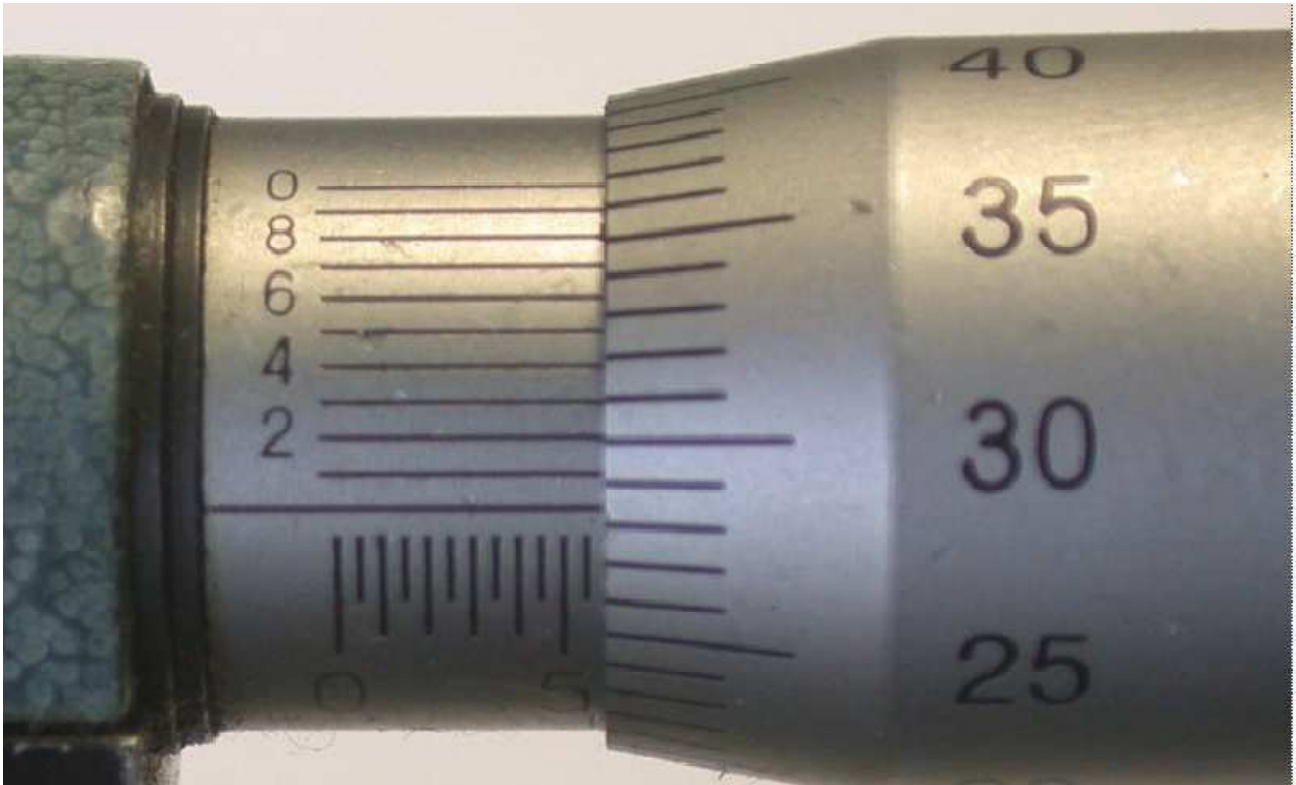
FIGURA 26: Ejemplo de un micrómetro con nonio
