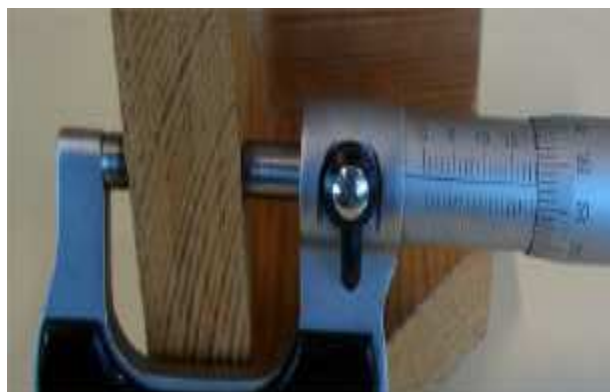
FIGURA 24: Ejemplo de una medición exterior con el Palmer.
