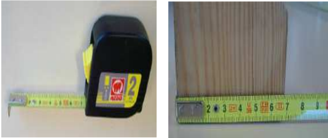
FIGURA 4: Ejemplo de flexómetro de 2 metros
