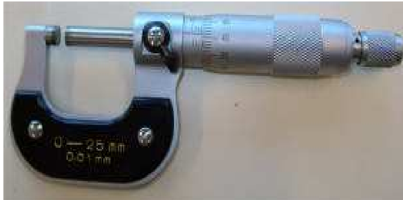
FIGURA 20: Micrómetro o Palmer.
