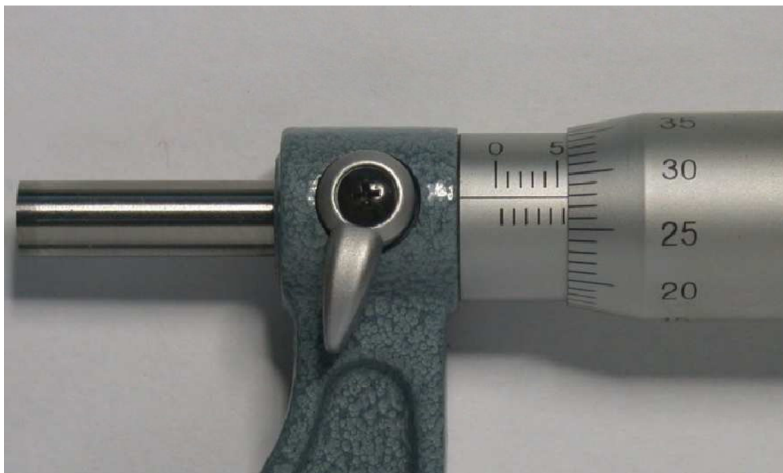
FIGURA 22: Ejemplo de una lectura de una medida con el Palmer.
