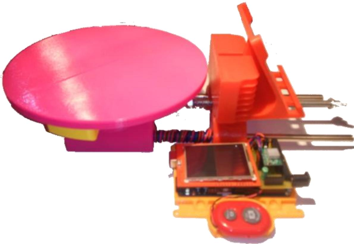
Escáner 3D “casero”, de diseño propio, **creado a partir de distintos diseños CICLOP 3D, diseños de Thingiverse...etc.** El resultado final es un escáner 3D económico, automático y de calidad.
