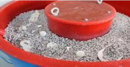
*Pulido con abrasivos:* **Pulido** por inmersión de la pieza en un **material abrasivo** colocado en un recipiente vibratorio o rotatorio
