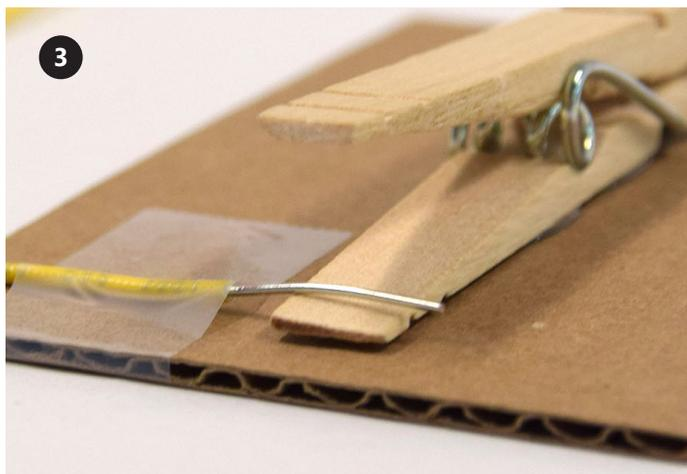
3 Pega un cable al cartón de tal forma que el extremo pelado quede sobre la punta de la parte inferior de la pinza para ropa.
