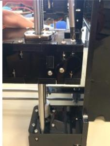
66. Ajuste de los tope de las varillas en el eje X.
