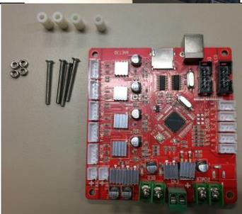
78. Instalación de la placa controladora de motores.
