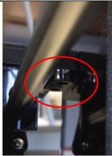
105. Ajuste del final de carrera del eje Z con una pieza adicional.
