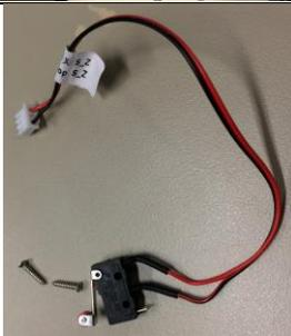
75. Colocación del final de carrera del eje X.
