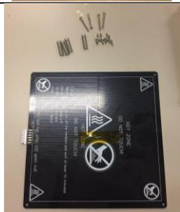
40. En la cama caliente, colocar cinta térmica para proteger las soldaduras.
