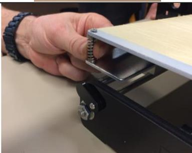
41. Sujeción y nivelado de la cama sobre soporte.
