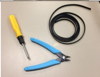
36. Medir, cortar y colocar la correa de arrastre de la cama caliente en el eje Y.
