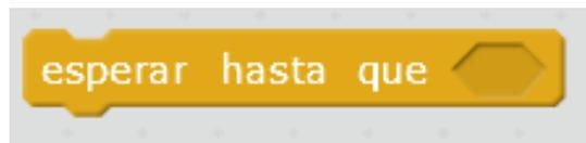
Podemos usarlo sin problemas con sensores porque va a estar esperando y mirando el sensor constantemente, cuando el sensor cambie, nos deja pasar.
