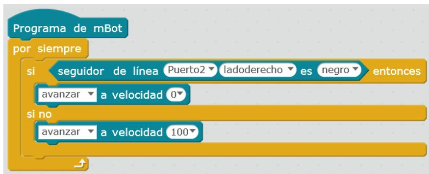
Para este sensor no necesitamos esperas, no hace falta meter nada en una variable, se evalúa una y otra vez.
