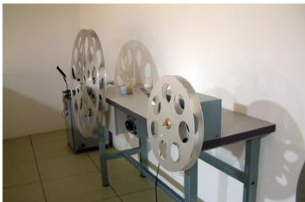
Bobinadora. Fuente: Intef. Fotógrafo: Pilar Acero López.
