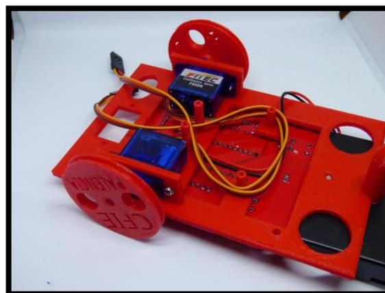
El siguiente paso será colocar las ruedas del robot, las cuales han sido diseñadas para que entren a presión en el eje del servo, pero además disponen de un agujero pensado para añadir un tornillo si fuese necesario para fijarlas al servo. Es importante sujetar el servo a la hora de presionar las ruedas y no hacer toda la fuerza sobre el soporte para evitar partirlo.
