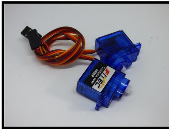
Para el movimiento del robot se utilizan dos servos de rotación continua modelo FS90R, que nos permiten girar 360° de manera indefinida con un buen par de arranque y una velocidad de 130 RPM, siendo alimentados a 6V.
