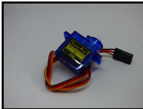
Además de los dos servos anteriores tenemos la posibilidad de montar un tercer servo de movimiento limitado ( $0^\circ - 180^\circ$ ) modelo SG90 sobre el que montaremos nuestro sensor de ultrasonidos para poder ser utilizado como radar y detector de obstáculos.
