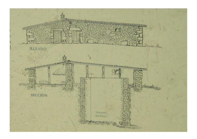
Alrededor de los pozos se construían refugios para evitar el calor del sol, ya que se trataba de mantener el hielo y la nieve el mayor tiempo posible. En el fondo del pozo poseen un desagüe con una salida subterránea para evitar la humedad, ya que la nieve no apoyaba sobre la tierra, si no sobre una cámara confeccionada con pequeños troncos para la filtración del goteo al deshacerse."
