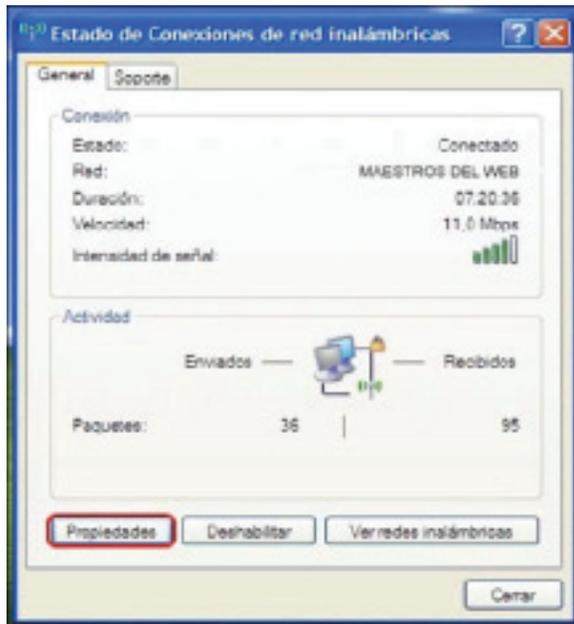
En la ventana de Estado de conexiones de las redes inalámbricas, nos muestra las características de la conexión: estado, red, duración, velocidad, intensidad de señal.
