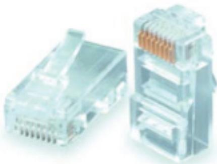
Una vez insertados los cables en el conector RJ45, procede a presionarlo mediante la crimpadora, que es una herramienta que empuja las cuchillas del conector a fin de penetrar la funda de cada alambre y establecer contacto con la parte metálica de éste. Luego mira de frente el conector y asegúrate que todas las cuchillas hayan penetrado la misma profundidad.
