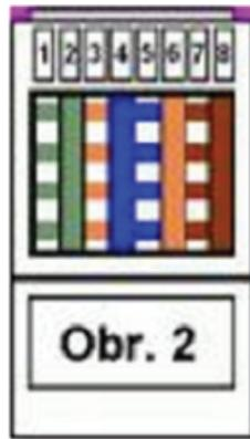
**Norma 568 A:** con el conector RJ45 con la pestaña hacia abajo, y mirando el conector desde arriba, el orden de los cables es:
