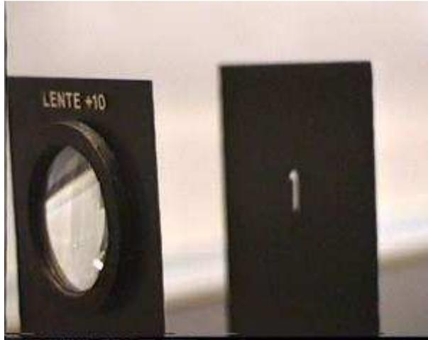
Encendemos la luz y se forma la imagen en la pantalla. Primero la luz del foco se concentra en el objeto y la de la luz que sale de la segunda lente da una imagen diferente según donde esté colocado el objeto. En este caso está a 10 cm y como la lente es de +5 cm de distancia focal está a  $2F$  y dará una imagen igual, real e invertida
