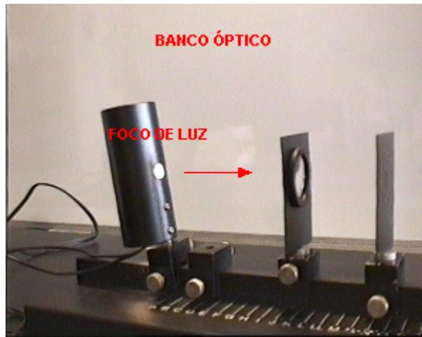
La primera lente convergente se emplea para concentrar la mayor cantidad de luz posible sobre el objeto (una figura de un "1" troquelada en una placa). El foco de luz debe estar en el foco de esa primera lente para que de ella salgan los rayos paralelos (para esta lente a 10 cm del objeto). En la siguiente foto aun no se encendió la luz.
