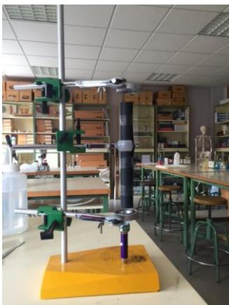
Se gira el analizador para observar que en una posición la cantidad de luz que pasa es máxima, los planos de polarización de polarizador y analizador tienen la misma dirección; mientras que en otra no pasa la luz, cuando los planos son perpendiculares. Hacemos las mediciones tomando como referencia la posición de máxima extinción de luz para ello giramos el analizador hasta conseguirlo.
