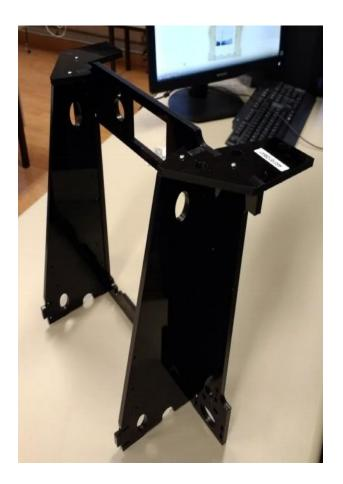
Se colocan las dos piezas superiores teniendo cuidado de que cada una vaya en el lado que le corresponde utilizando tornillos (M3x18mm, 4 unidades) y tuercas (M3mm, 4 unidades) de forma análoga al anterior ensamblaje.
