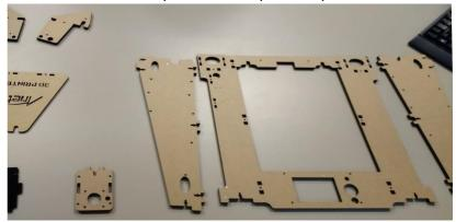
Estas piezas han de quedar limpias de los protectores que tienen y quedan "negras" como la pieza de la foto. No utilizar ningún elemento raspante, se puede dañar la superficie.
