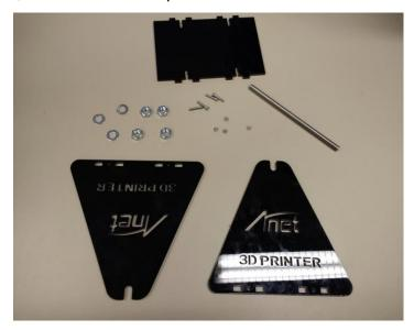
Para ello necesitamos las piezas correspondientes, una varilla roscada corta, tornillos (M3x184mm, 4 unidades), tuercas (M3mm), arandelas (M8, 4 unidades) y tornillos (M8mm).
