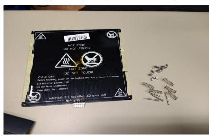
Los muelles han de ir colocados de forma correcta: ni muy tensos ni muy flojos. Primero se colocan los muelles y los tornillos y después lo dejaremos a la altura requerida con las mariposas.
