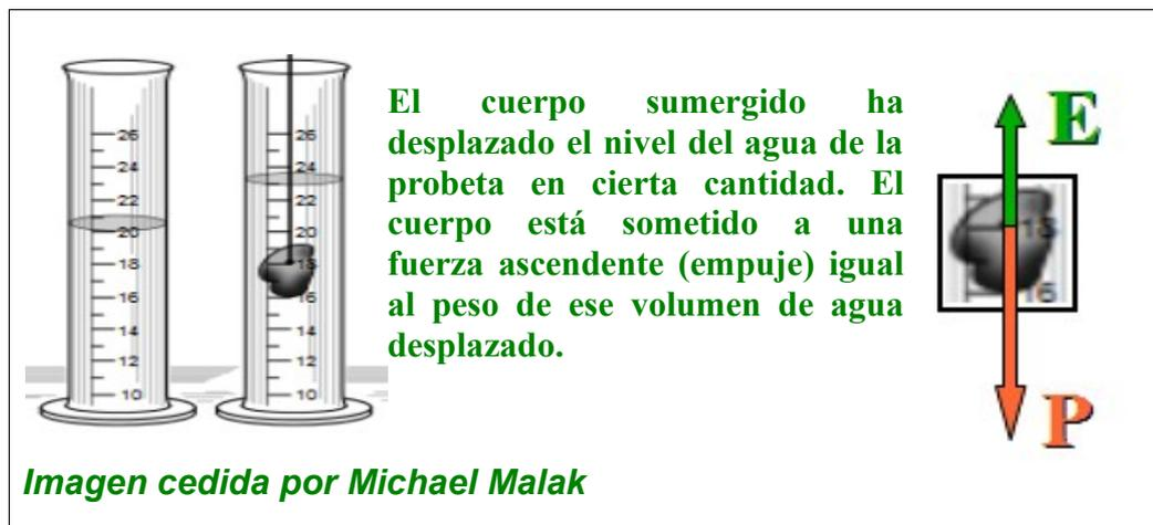
Como se observa en la imagen anterior, el cuerpo que se sumerge en el agua de la probeta está sometido, por un lado, a la fuerza de atracción gravitatoria terrestre, es decir, su peso, y por otro lado está sometido a la fuerza que ejerce el peso de agua que ha desalojado al sumergirse en ella, el **empuje**, como se desprende del Principio de Arquímedes.
