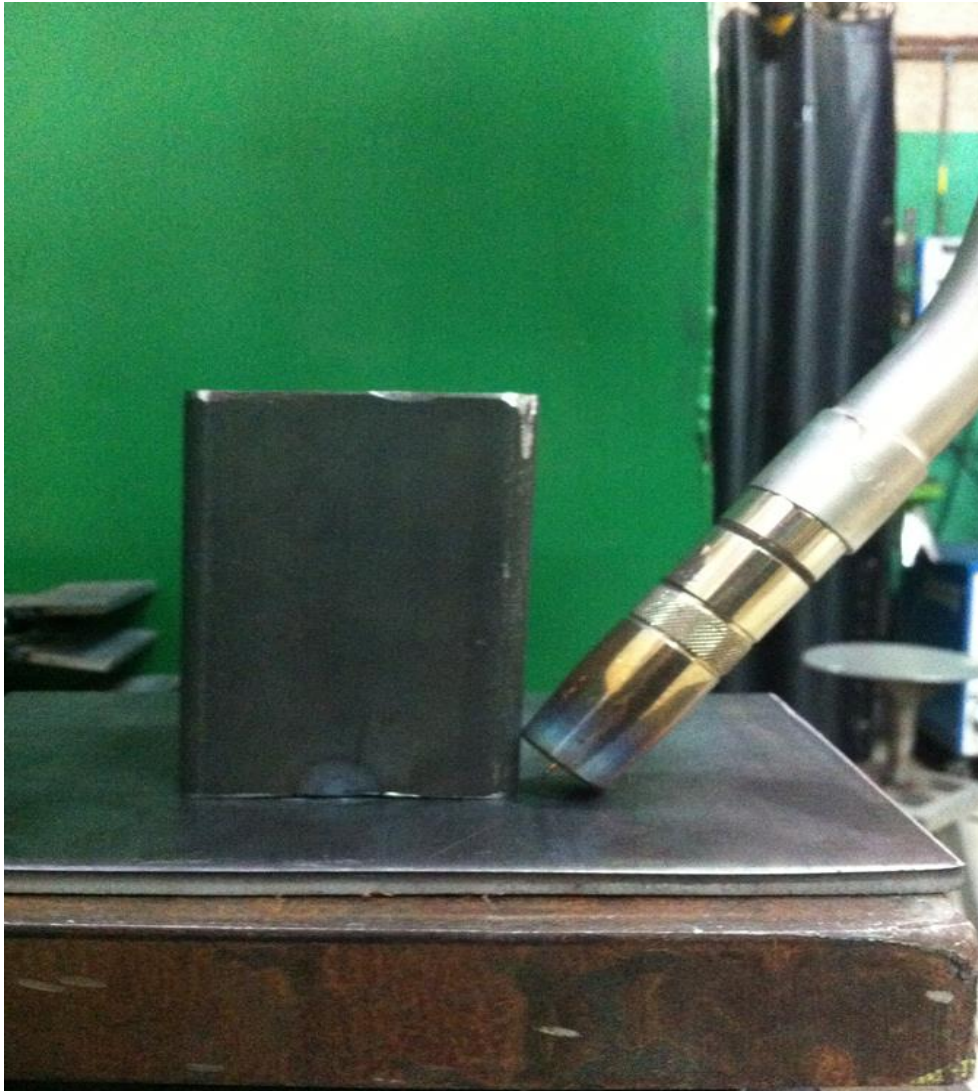
Foto pistola de soldadura con probeta de práctica.
