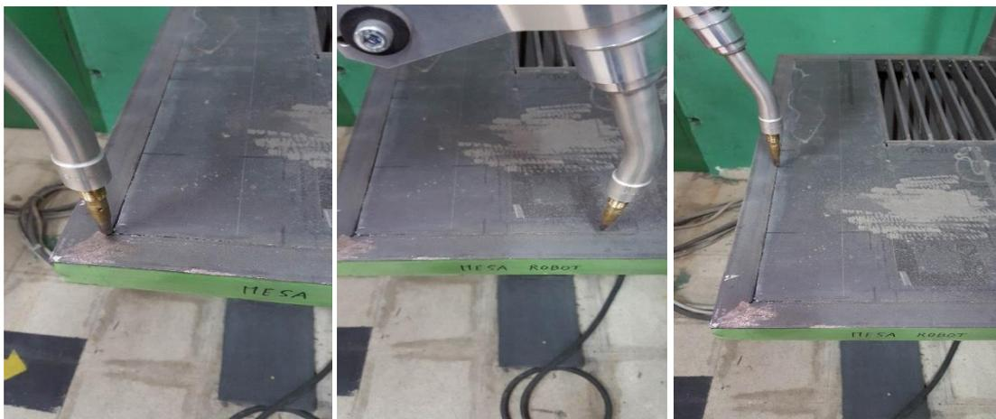
Definir los tres puntos de la mesa siguiendo el método utilizado en la Práctica 04, para definir los puntos de la herramienta PISTOLA1, (acercarse manualmente con el robot
