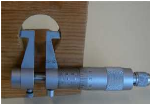
FIGURA 25: Ejemplo de una medición interior con el Palmer.
