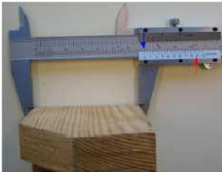
FIGURA 17: Ejemplo de medición exterior con calibre.
