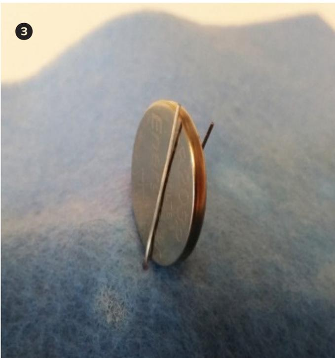
Voltea el acolchado e inserta la batería tal y como se muestra. Verifica que el LED se encienda, de no ser así, invierte la polaridad del circuito al cambiar de dirección la batería.
