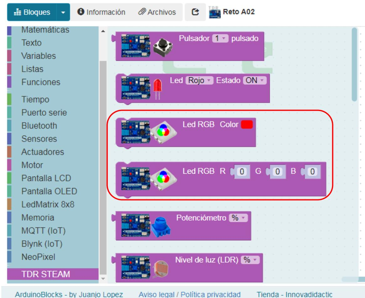
Continuando con la práctica anterior, ahora vamos a controlar la intensidad de un led utilizando la modulación PWM. Pero antes vamos a explicar cómo funciona la modulación PWM. PWM es la abreviatura de **Pulse-Width Modulation** (modulación de ancho de pulso). Las salidas digitales de Arduino sólo tienen dos estados: **ALTO/BAJO**, **ON/OFF**, **ENCENDIDO/APAGADO**. Es decir, corresponden a una salida de 5 V (ON) y
