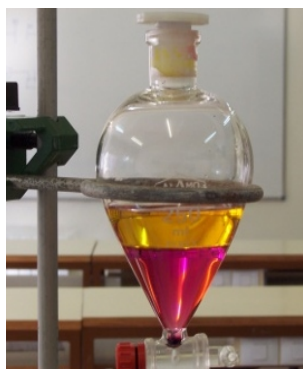
Embudo de decantación. El líquido menos denso (amarillo), flota encima del líquido más denso (rosa)
