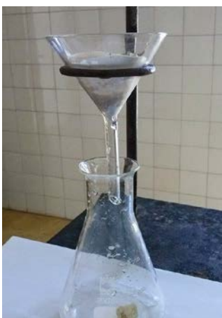
Mediante la filtración separamos las sustancias insolubles de una mezcla.
