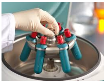
Centrifugadora. Mediante rotación a altas velocidades conseguimos separar componentes de distinta densidad
