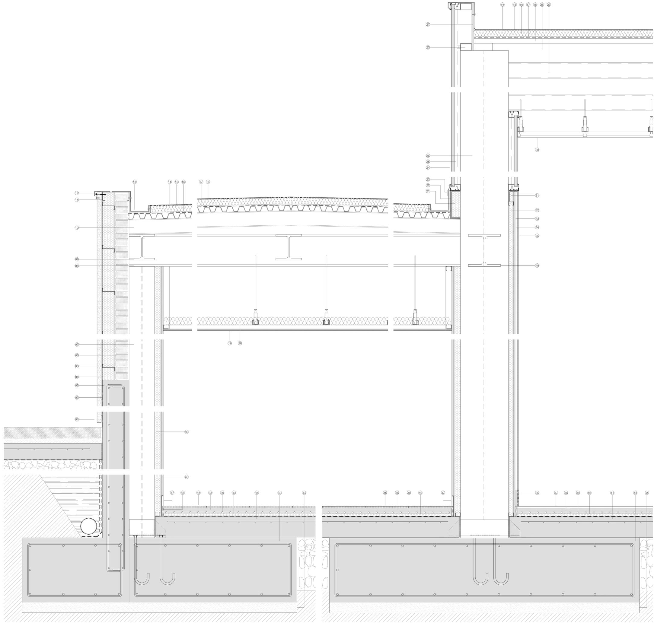
1. - PANEL SANDWICH DE FACHADA DE 30 mm DE ESPESOR. ACABADO DE CHAPA DE ACERO GALVANIZADO TERMOLACADO
