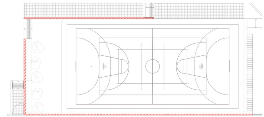
**MUROS EXISTENTES DE HORMIGÓN ARMADO**
