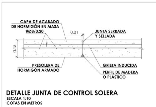
**DETALLE JUNTA DE CONTROL SOLERA**
