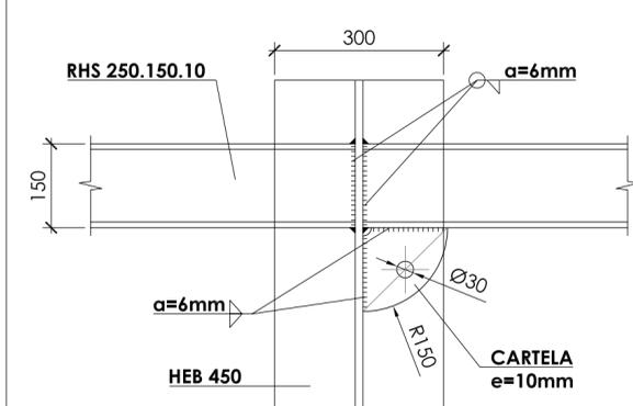
**DETALLE 4. UNIÓN PILAR - CABLE**
