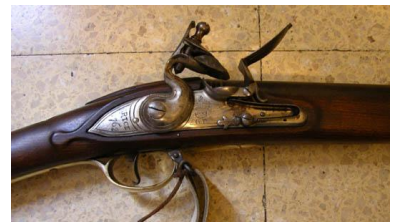
El mecanismo de la llave de chispa de pedernal en el mosquete lo hacía más seguro y eficaz para el soldado. La llave de pedernal consistía en una piedra de pedernal montada en el martillo, que golpeaba el pie de gato de la cazoleta, abriéndola y produciendo una chispa. Esta encendía la pólvora fina y su llamarada disparaba el arma.
