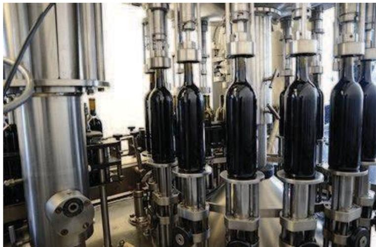
mecánica) para el acondicionamiento final del vino con el objeto de realizar su expedición y venta final al consumidor. Las botellas actuales tienen un volumen estándar de 750 mL. Un elemento importante en el embotellado es la encapsulación que puede emplear tapones de materiales naturales (tapón de corcho), semisintéticos, sintéticos y cápsulas metálicas.
