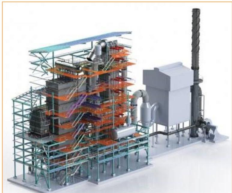
Las entradas a la caldera son la biomasa a quemar y el aire en forma de aire comprimido para efectuar la combustión de la biomasa. Existe un dosificador de ambos reactivos para efectuar una combustión adecuada.
