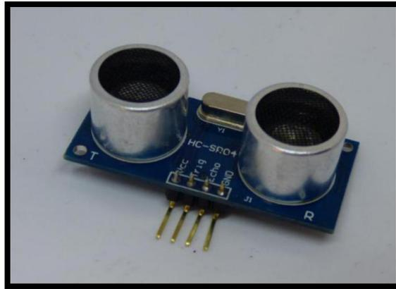
Sensor de ultrasonidos modelo HC-SR04, muy utilizado en Arduino y compatible con multitud de librerías y módulos. Es de bajo coste y nos permitirá medir distancias y conocer si tenemos algún obstáculo en la trayectoria de **Simplibot** actuando en consecuencia.
