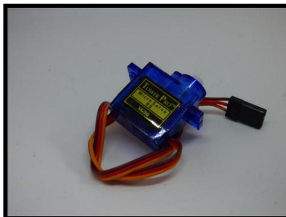
Además de los dos servos anteriores tenemos la posibilidad de montar un tercer servo de movimiento limitado (0° - 180°) modelo SG90 sobre el que montaremos nuestro sensor de ultrasonidos para poder ser utilizado como radar y detector de obstáculos.
