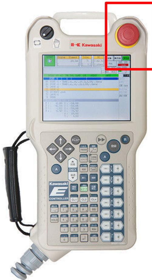
Cuando se pulsa la seta de emergencia, se desconecta la alimentación a los motores y se para el robot.
