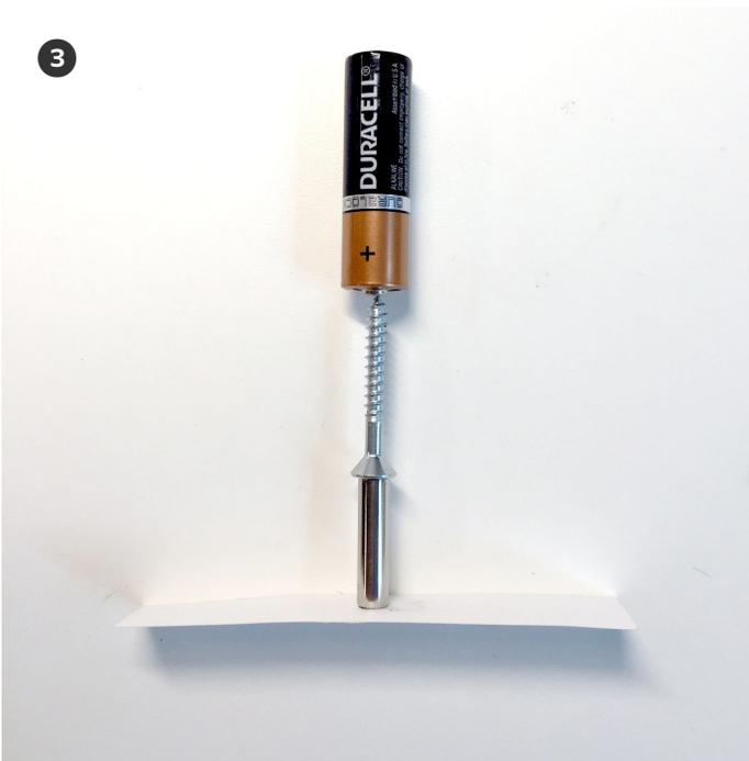
3 Conecta la parte puntiaguda del tornillo a la parte inferior de la batería. Usa el extremo positivo de la batería, ya que le da un punto de agarre al tornillo. Para este momento, el imán debería mantener el dispositivo unido.
