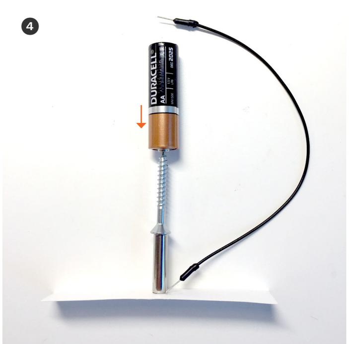
4 Sostén la batería de tal forma que el tornillo y el imán cuelguen de manera vertical hacia abajo. Conecta un extremo del cable a la batería y el otro al imán. ¡Observa como gira la hélice!
