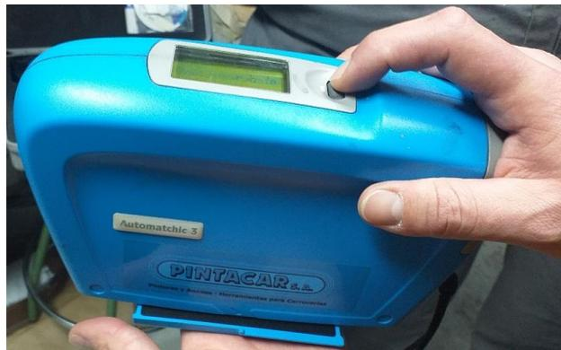
Una vez calibrado procedemos a realizar la captura del color en el panel trasero del Seat Arona. Se realiza seleccionando el archivo donde vamos a guardar el proceso y en diferentes capturas cambiando la angulación del medidor encima de la pieza:
