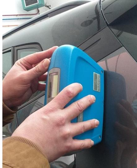
Una vez realizadas las capturas del color, guardamos los datos y conectamos el espectrofotómetro al equipo informático a través de un cable USB, abrimos el programa de gestión del color Sics de la marca Sonne y descargamos la información contenida.
