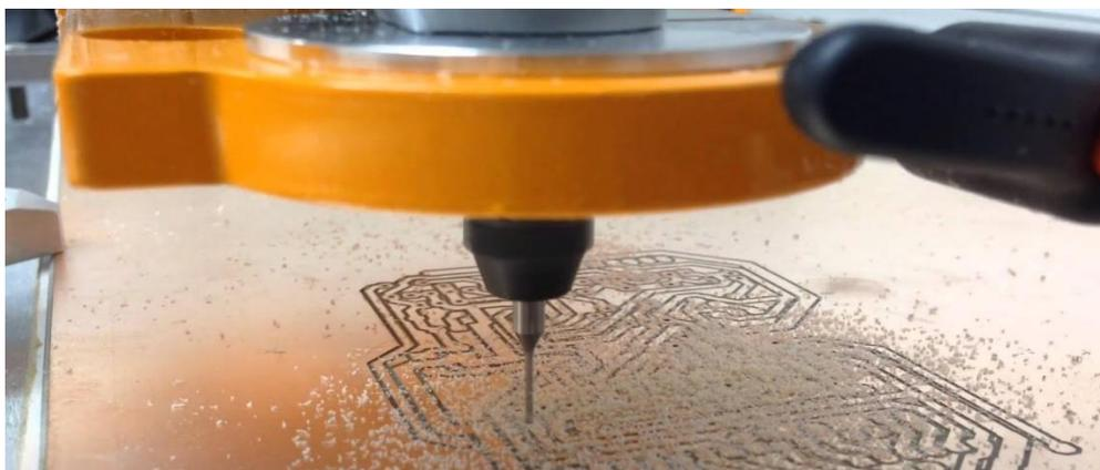
*Fresadora StepCraft fabricando una PCB*
