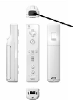
El acelerómetro el sistema usado para detectar movimientos lineales.
