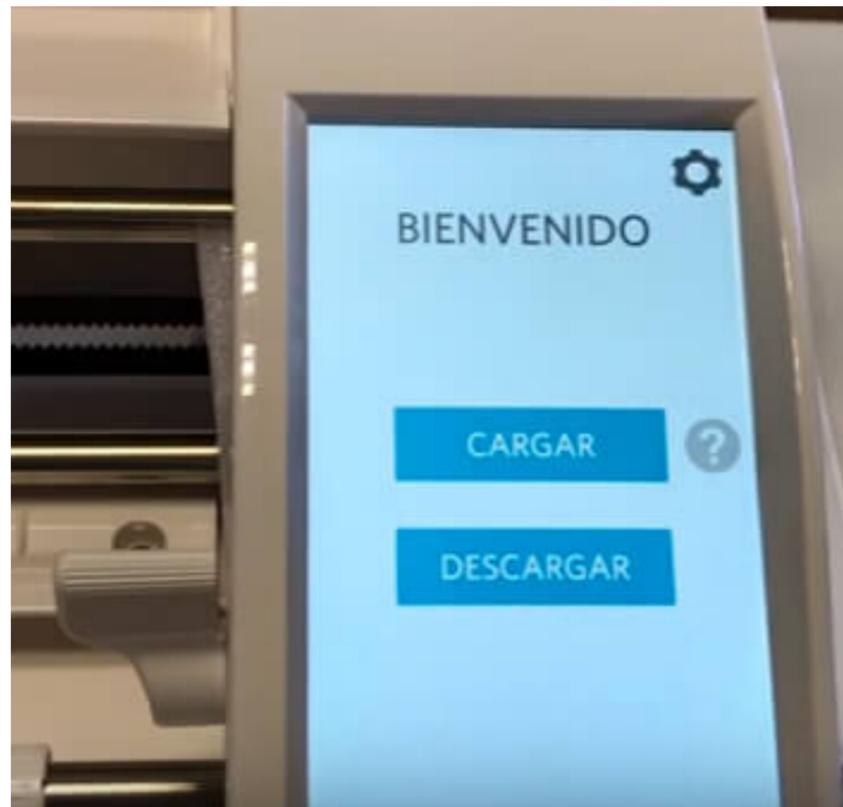
El panel de control de la máquina es la pantalla LCD.
