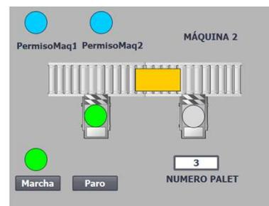
Aquí vemos los dos tramos de rodillos de la máquina 2 una vez que se ha puesto en marcha y el paquete ya está siendo transferido, momento en el que las dos máquinas tienen el permiso activo. Cuando el paquete ya se encuentre ocupando los rodillos de la máquina 2 y ya no necesite de la máquina 1 para transferirlo, retirará el permiso PermisoMaq2.
