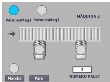
Aquí vemos los dos tramos de rodillos de la máquina 2 antes de ponerla en marcha. Se puede apreciar cómo la máquina 1 tiene activado su permiso, y la máquina 2 aún no se ha puesto en marcha, por eso, no tiene activado el permiso PermisoMaq2.
