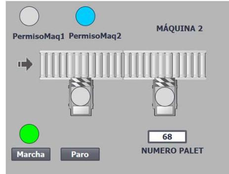
Aquí vemos los dos SCADAS de las dos máquinas de manera simultánea, donde se puede apreciar que la máquina 2, ofrece activo el permiso porque está en marcha y porque no está ocupada transfiriendo ningún paquete.
