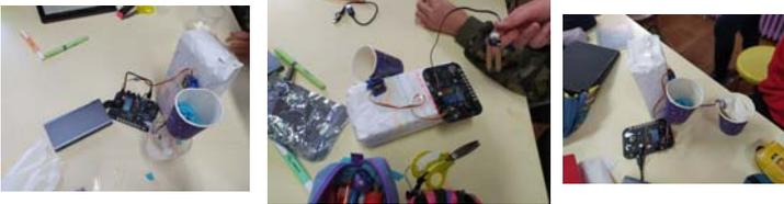
Un vez terminado, abrimos la aplicación IoT y realizamos el experimento. Observamos que si la humedad del medidor es escasa, se activa el motor y hace que el vaso gire y si mojamos el aparato de humedad el vaso permanecerá sin moverse, pues la medición es correcta.
