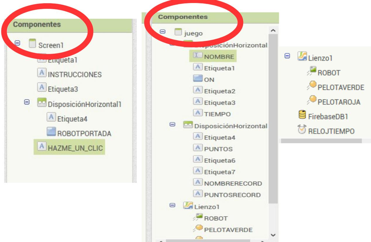
Los dos componentes no visibles del proyecto en la pantalla “juego” son el RELOJTIEMPO y la FIREBASE DB. El reloj lo encuentras en el menú *sensores*. Nos servirá para medir el tiempo del juego. La Base de datos externa para guardar el record la encuentras en el menú *Experimental*.
