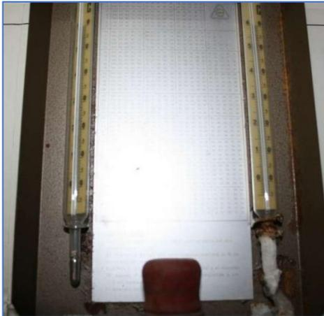
TERMOMETRO Y MEDIDOR HUMEDAD
