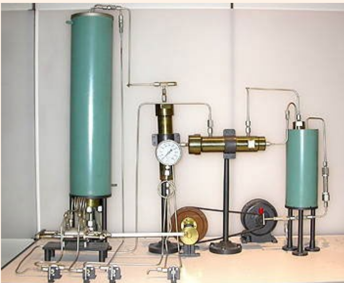
Equipo de laboratorio de Haber para la producción de amoníaco.
