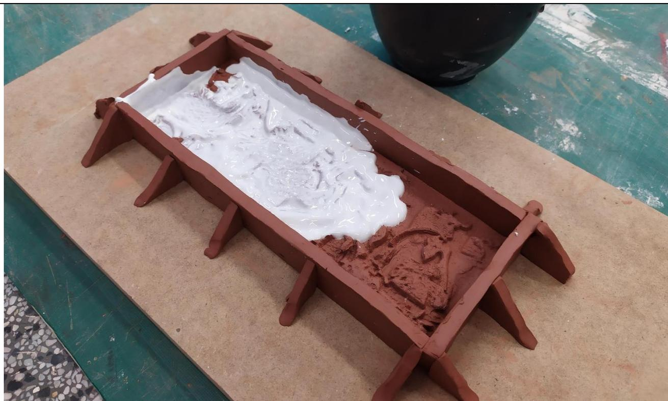
Terminamos de verter la escayola con ayuda de la cuchara dentro del encofrado. Vibraremos ligeramente la tabla para poder sacar el resto de las burbujas que pudieran quedar dentro de la escayola.
