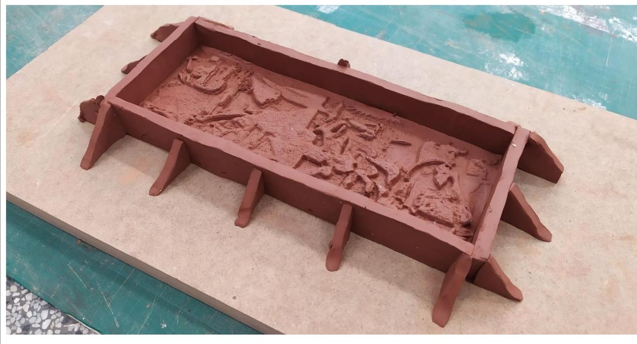
En el Bol preparamos escayola para verterla dentro de nuestro encofrado con ayuda de la cuchara. Primero se rellena el bol hasta la mitad de agua, después se va vertiendo la escayola dentro del agua tenemos que intentar que no queden grumos. Cuando este saturada el agua de escayola batiremos con la cuchara, hasta que la mezcla sea homogénea. Esperaremos unos minutos para poder verter dentro la escayola.
