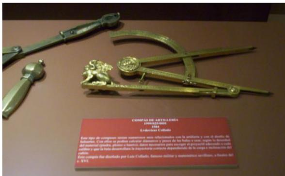
Compás de artillería firmado por Luis Collado (1584) «con el cual se podían realizar medidas de distancias y de ángulos de inclinación, así como obtener el peso de un proyectil dependiendo del material del que está fabricado y su calibre». Museo Nacional de Ciencia y Tecnología.
