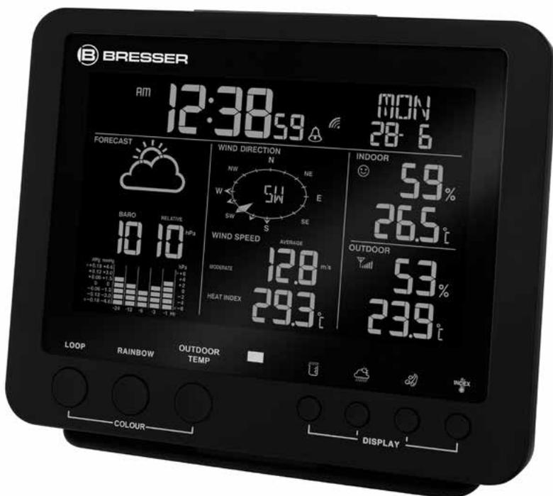
Estación meteorológica con sensor múltiple y sin cables
