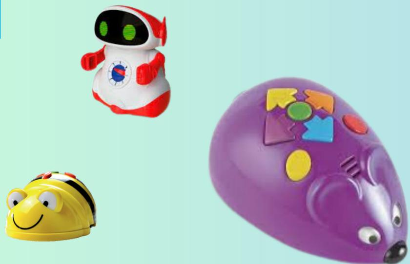
ROBOTS AUTÓNOMOS CON PULSADORES QUE PUEDEN SER PROGRAMADO SIN NECESIDAD DE UN EQUIPO INFORMÁTICO.
