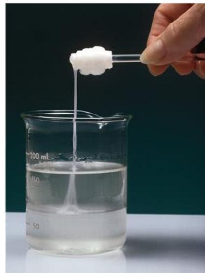
**Procedimiento:** Se disuelve en los vasos de 50 mL una pequeña cantidad de cloruro de adipoilo (1 o 2 mL) en unos 20 mL de tetracloruro de carbono y una pequeña cantidad (1 gramo aproximadamente) de hexametilendiamina en cantidad similar de agua destilada alcalinizada con unas gotas de hidróxido de sodio al 20%.
