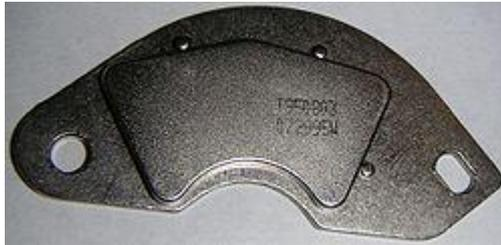
**Figura x.** Imán de neodimio niquelado procedente de un disco duro.
