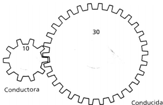
b) ¿Se produce un aumento o una disminución de la velocidad de giro? ¿Cómo se debería variar el diseño del mecanismo para que ambas ruedas giren en el mismo sentido sin variar la relación de transmisión?
