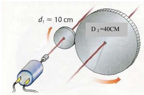
i. Calcula la relación de transmisión en el sistema de ruedas de fricción de la figura.
