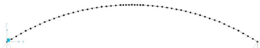
Vista del modelo de elementos finitos de la bóveda
