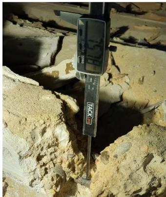
Foto 3. Medida del recubrimiento superior
