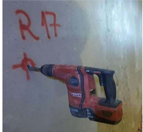
FOTOS 32 y 33 – Taladros realizados en muros de sótano para determinar su espesor. En este caso son los taladros 5 y 6 realizados por INCOSUMA.
