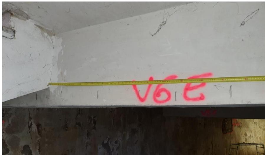
FOTO 62 - Pachometría realizada en una de las vigas de canto del escenario. Se comprobaron la distancia entre los estribos junto al apoyo de la viga en el muro.
