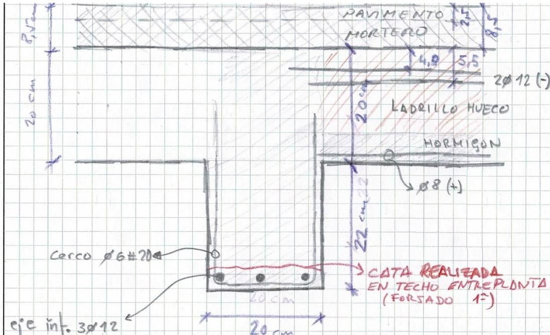
NOTA: El armado del forjado representado en el croquis es el correspondiente al forjado de entreplanta
