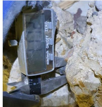
Foto 2. Medida del diámetro de la armadura longitudinal
