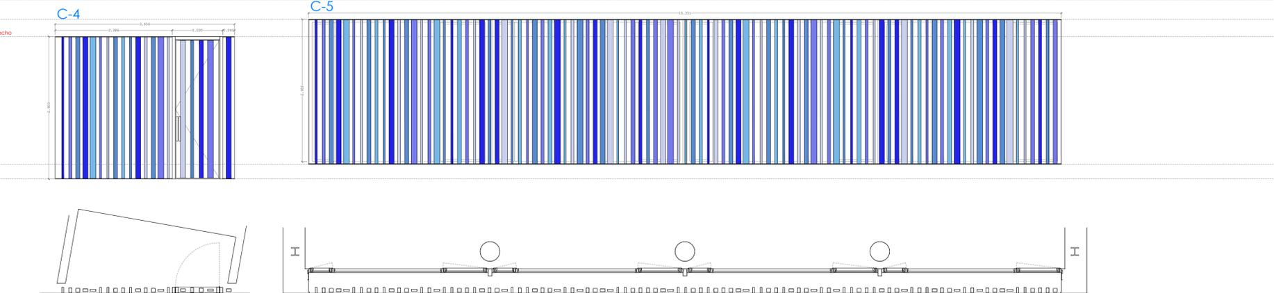
C-4 1 UDS. CELOSIA FIJA + HOJA ABATIBLE. CIERRE DE FACHADA FORMADO POR CELOSIA FIJA REALIZADO MEDIANTE PERFILES DE ACERO PARA PINTAR, DE DIFERENTES SECCIONES 120x40, 100x40, 80x40 Y PUERTA DE HOJA ABATIBLE FORMADA POR MOLDUR DE PERFIL DE ACERO 120x60, Y HOJA CON CELOSIA
