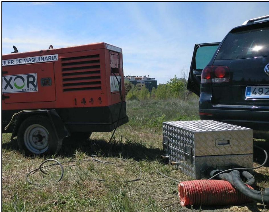
Figura 15. Test de Respuesta Térmica en Villimar, Burgos. 06.05.2019
