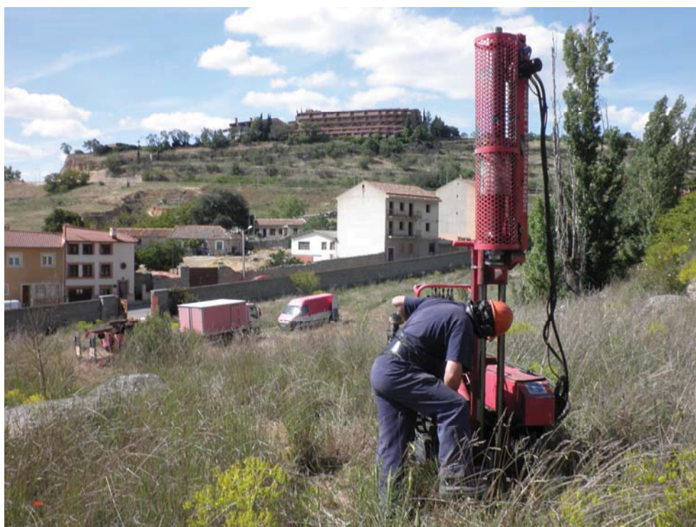
VISTA “D”. PENETRACIÓN DINÁMICA D-12
