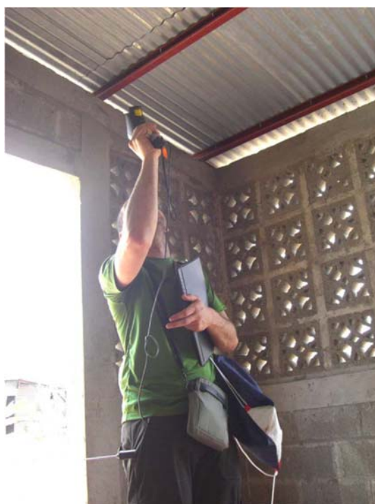
Medición de temperatura en cubierta
