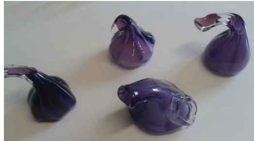
Bocetos soplados preliminares de los maestros vidrieros. Pruebas de forma.
